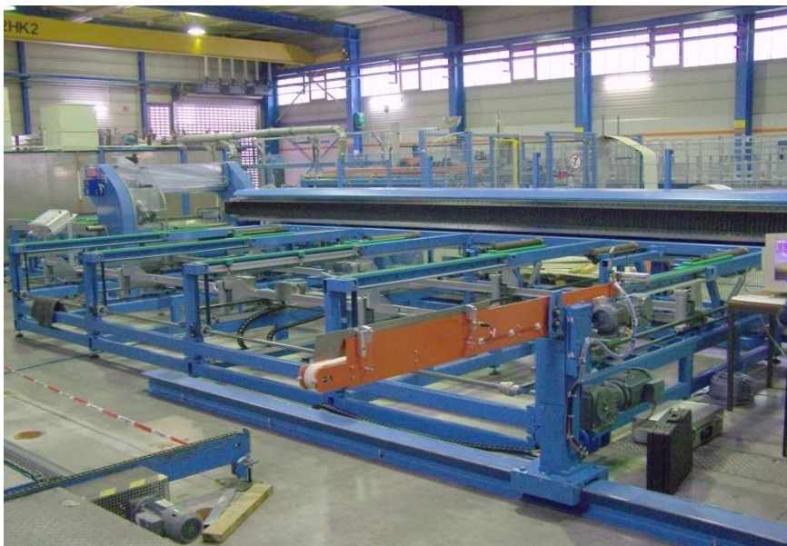
Vorlängentisch mit Pufferband, zwei NC – Hubübersetzer für pufferbare und nicht pufferbare Profile. Im Vordergrund der Übersetzarm für die Ein-Mann Bedienung, dieser kann auf die jeweilige Profillänge eingestellt werden. Für nicht pufferbare Profile, würd der Übersetzer eingerichtet für vertikalen Hub zum automatischen Einlegen der Profile in die Hubübersetzkammern der Übersetzers 1. Für Pufferbare Profile wird der Übersetzer eingerichtet auf Schenkbetrieb.
