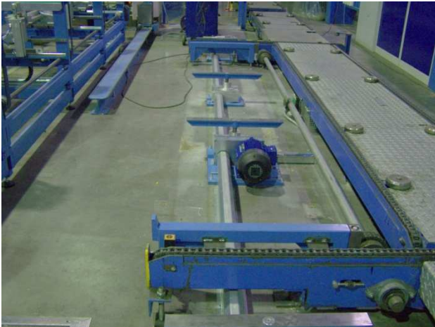
Aushebevorrichtung zum Ausheben der Profile aus dem Vorlängengestell, Tragfähigkeit 1,6to
