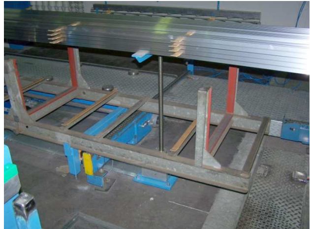
Ausgehobene Profile, der Antrieb ist Frequenzgeregelt und die Trapezgewinde-spindel werden über selbstgefertigte Hubgetriebe 1200mm in den Boden gefahren
